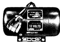
18-(12-)Volt-Umformer Eingang 18 Volt =, 3,2 Amp.; Ausgang 450 Volt =, 3,2 Amp. Der Typ ist auch an 12-Volt-Gleichstrom anzuschließen, die Anodenspannung ist dann 310 V =, 44 mA; 88 mm Ø x 155 mm x 100 mm; ca. 2,90 kg. Sehr guter Zustand, geprüft . . . DM 18.—
