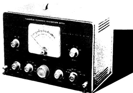
In Verbindung mit einem klirrfarmen RC-Generator (z.B. Heathkit AG-9 A) zur Klirrfaktormessung von 20 Hz... 20 kHz. Das Meßergebnis wird auf der linearen Skala direkt in % angezeigt.
